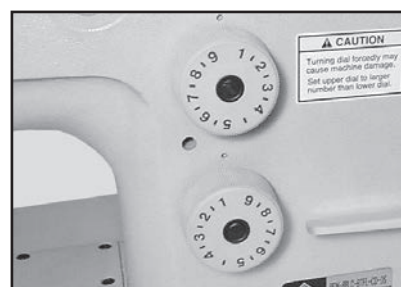
用途に応じた送りピッチの切り替え (DS機構)
