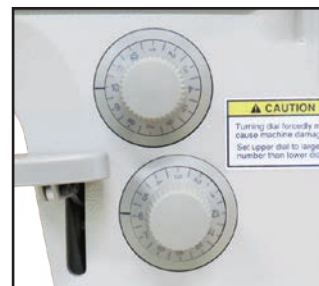
用途に応じた送りピッチの切り替え (デュアルステッチ機構)
