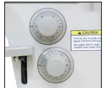
用途に応じた送りピッチの切り替え(デュアルステッチ機構)
