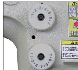
用途に応じた送りピッチの切り替え (DS機構)
